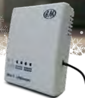
Ein CO 2 -Messgerät misst den CO 2 -Anteil in der Wohnungsluft.
